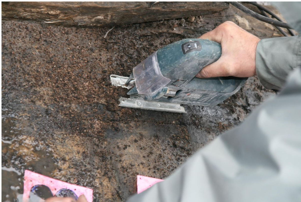
Udtagning af prøve til dendrokronologi ved hjælp af en elektrisk stiksav Foto: NIKU, 2009
