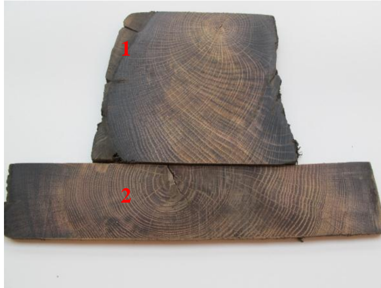
Fig. 4. Prøver af eg fra fundament fra Kampen (Foto: Rene Klaassen)
