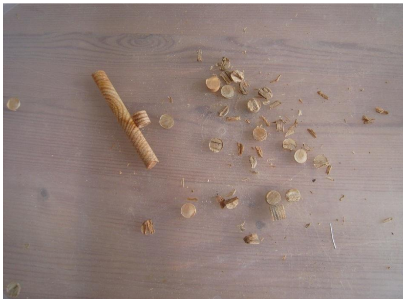
Figur 1: Her ses hvordan de enkelte årringe smuldre fra hinanden efter prøvetagning. Her er der kun 19 årringe tilbage ind mod marven og prøven må kasseres.
