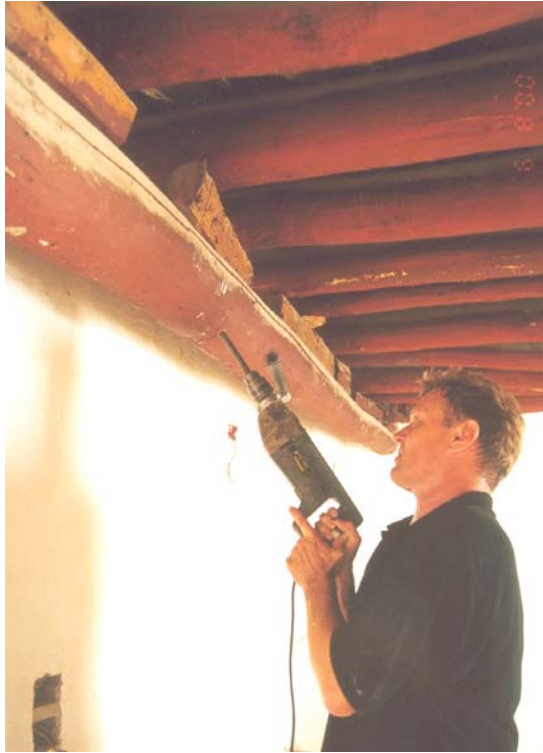
Abbildung 9 Probe 37. Book-Tower (auch 'Secret Room' genannt) in der Südwest-Ecke des Gebäudes. Deckenbalken in Wandnähe, Durchmesser ca. 20cm. Das Foto zeigt die Entnahme einer Bohrprobe.
